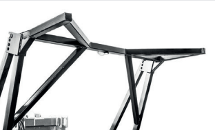
机械或液压防护架可引导材料并将其推离托架
